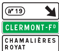
D31d Panneau de signalisation avancée de sortie numérotée.
