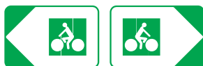
Dv21c (ex 1) Dv21c (ex 2) Panneau directionnel de position sans indication de destination et de distance.
