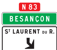
Da31e Panneau de signalisation avancée de voie de sortie non numérotée.
