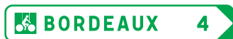
Dv21a Panneau de position comportant une indication de destination et une indication de distance.
