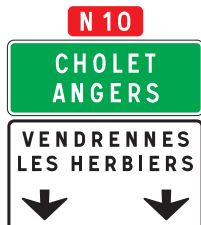
Da31b Panneau de signalisation avancée d'affectation de voies de sortie non numérotée.
