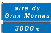
D46a Présignalisation d'une aire de service ou de repos sur autoroute.
