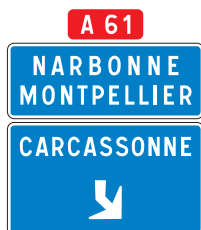
Da31f Panneau de signalisation avancée d'affectation de voies de bifurcation autoroutière.
