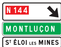
D31e Panneau de signalisation avancée de sortie non numérotée.
