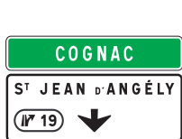
Da31a Panneau de signalisation avancée d'affectation de voies de sortie numérotée.
