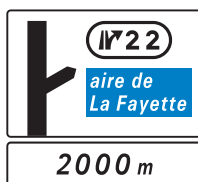
D51cr Panneau d'avertissement de sortie simple donnant également accès à une aire de service ou de repos.
