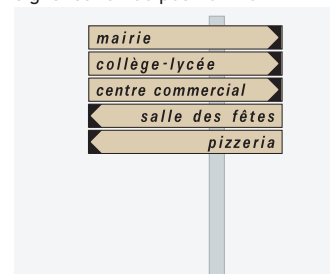
signalisation de position Dc29
