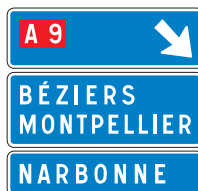
D31f Panneau de signalisation avancée de bifurcation autoroutière.
