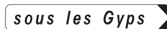
D29b Panneau de position destiné à signaler les lieux-dits et les fermes ne comportant pas d'indication de distance.
